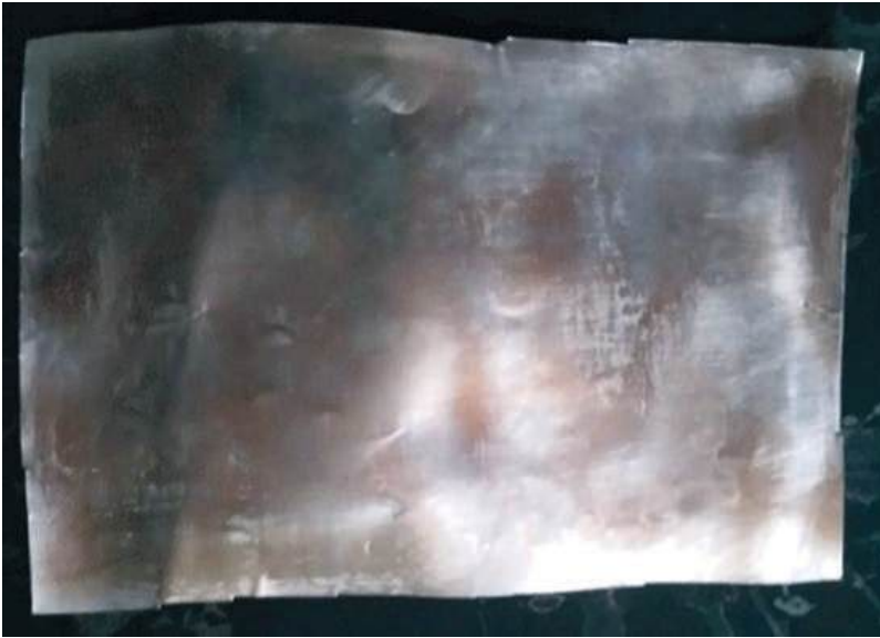
Figura 6. Placa Aluminio pulida, conductor eléctrico
