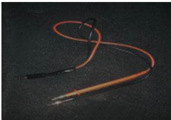
Figura 15. Terminales para medición con celular
